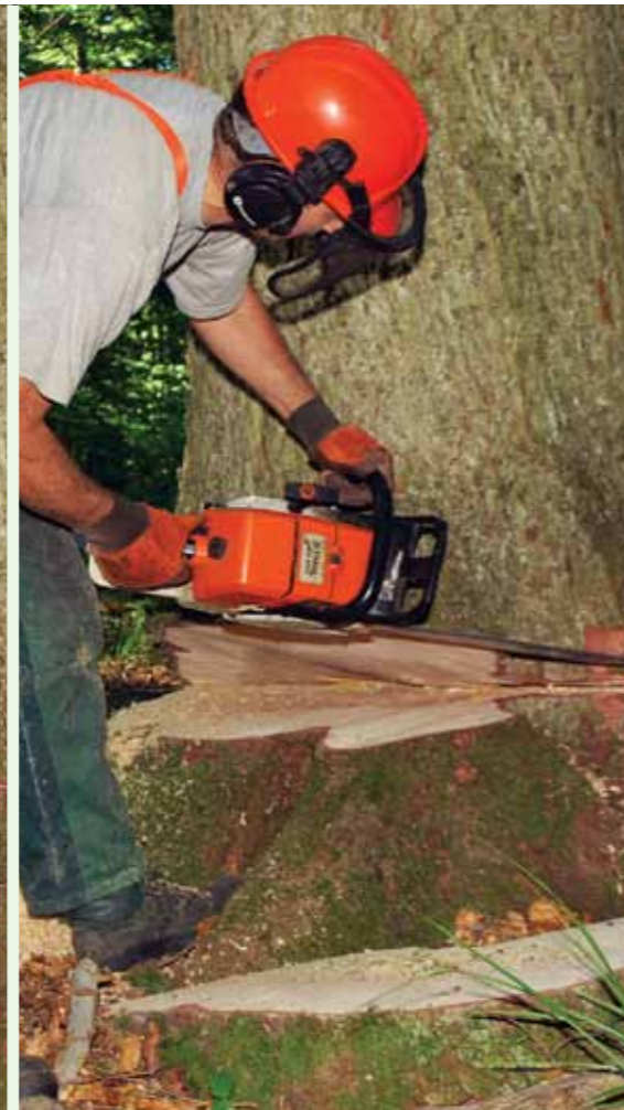
Zasjek usmjerava pad stabla u željenom smjeru
