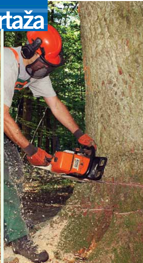
Zasjek usmjerava pad stabla u željenom smjeru
